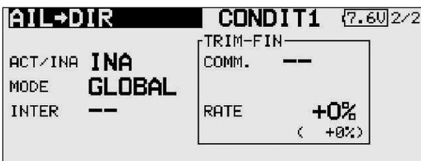
Cette fonction de mixage aussi doit d'abord être activée dans la ligne 'ACT/INA'. Marquez d'abord la fenêtre, réalisez le réglage avec le 'bouton 3-D' et activez en actionnant EDIT. Ensuite dans la fenêtre apparaît la position de l'interrupteur 'ON' ou 'OFF'.
