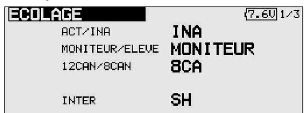
Dans ce menu il est possible d'établir l'ensemble des réglages initiaux pour le mode moniteur-élève. Après avoir marqué l'option souhaitée à l'aide du bouton 3D, exécutez la modification des réglages à l'aide de mouvements rotatifs du 'bouton 3-D'.
