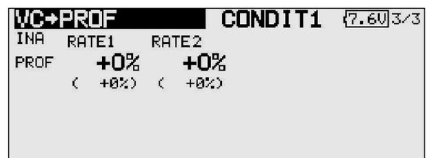
Cette fonction de mixage aussi doit d'abord être activée dans la ligne 'ACT/INA'. Marquez d'abord la fenêtre, réalisez le réglage avec le 'bouton 3-D' et activez en actionnant EDIT. Ensuite dans la fenêtre apparaît la position de l'interrupteur 'ON' ou 'OFF'.
