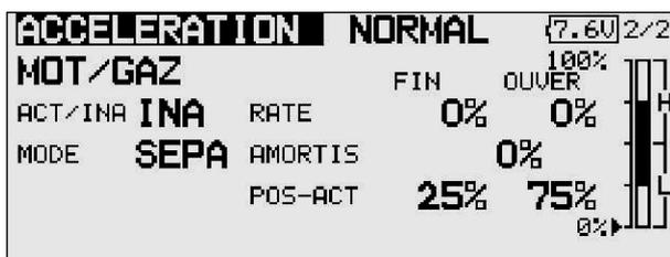
Les deux niveaux sont séparés pour les réglages du pas et pour les réglages des gaz. Dans le premier niveau on saisit les instructions concernant le pas et dans le second les instructions concernant la fonction des gaz. Les deux mises au point peuvent être réalisées de manière parfaitement identique. Seules les désignations 'min' et 'max' des réglages du pas s'appellent pour les réglages de gaz 'FIN' (ralenti) et 'OUVERT' (carburateur ouvert) pour les états du carburateur.
