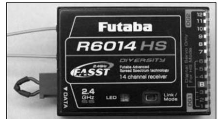
un pont de brancher sur les données d'entrée du récepteur, les canaux 11 +12 pour Multiprop activé.
