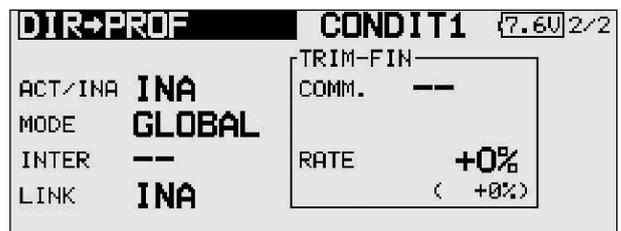
Cette fonction de mixage aussi doit d'abord être activée dans la ligne 'ACT/INA'. Déterminez ensuite si c'est le mode 'Global' ou le mode 'Séparé' qui entre en vigueur. Déterminez ensuite l'interrupteur et son sens d'actionnement. La programmation préalable se trouve sur Zéro ('NULL').
