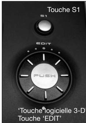
La navigation de l'ensemble de radiocommande FX-30 est conçue de manière simple et logique. La 'touche logicielle 3D' et la touche de sélection S1 servent de guide dans le menu.
