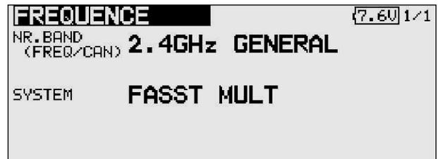
Pour les divers récepteurs FASST 2,4 GHz, sélectionnez le type de modulation suivant:
