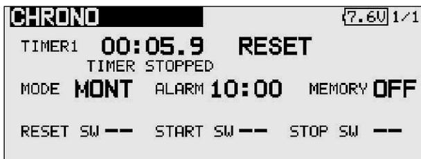
Pour remettre une montre à zéro, il est possible d'actionner l'interrupteur prévu à cet effet. Il est également possible de repérer la zone de RAZ ('Reset') de la fonction horaire concernée et confirmez à l'aide de la touche 'EDIT'.
