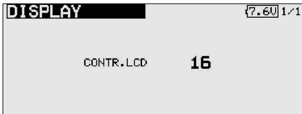
Activez la fenêtre 'CONTR.LCD' et modifiez le réglage du contraste en tournant le 'bouton logiciel 3-D'. La rotation vers la gauche rend l'écran plus clair et la rotation vers la droite assombrit l'écran.
