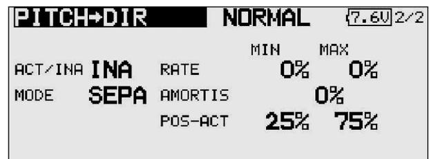
Dans le second écran il faut d'abord activer le dispositif de mixage. Marquez d'abord la fenêtre, réalisez le réglage avec le 'bouton 3-D' et activez en actionnant EDIT. Ensuite dans la fenêtre apparaît la position de l'interrupteur 'ON' ou 'OFF'. Les incidences et les valeurs prédictives établies des modes 'Global' ou 'Séparé' sont décrites plusieurs fois par ailleurs. Elles sont programmées dans la ligne 'Mode'.
