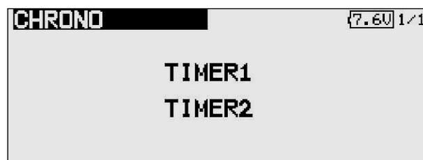
Dans ce menu principal de l'horloge intervient d'abord la sélection du chronomètre pour laquelle des mises au point doivent être exécutées. Marquez la fonction souhaitée et actionnez la touche 'EDIT'. Pour l'horloge 1 (Timer 1) l'écran se présente comme suit:
