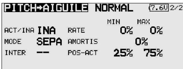
Dans le second écran il faut d'abord activer le dispositif de mixage. Marquez d'abord la fenêtre, réalisez le réglage avec le 'bouton 3-D' et activez en actionnant EDIT. Ensuite dans la fenêtre apparaît la position de l'interrupteur 'ON' ou 'OFF'.
