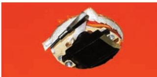
**Il faut légèrement entailler le coffrage d'intrados pour assurer le maximum de débattement au servo et à la commande de volet. Ces découpes sont ensuite invisibles une fois le cache en ABS collé.**
