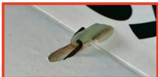
**La sortie de commande de volet se fait à l'extrados et les guignols en fibre ont une forme spéciale qui permet un fort débattement vers le bas. Ici aussi, un petit carénage thermoformé vient protéger cette sortie.**
