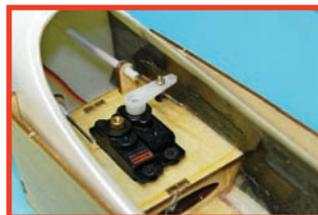
**Voici le montage prévu pour les commandes des empennages. Avec le domino sous le palonnier, serrer la vis de pression est pour le moins délicat...**
