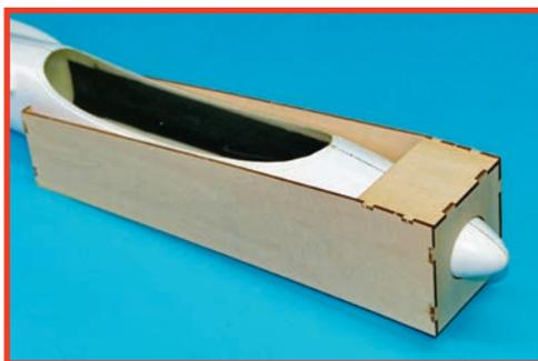
**Voici le gabarit de coupe du nez assemblé et placé sur le fuselage. C'est une aide vraiment bien pensée !**
