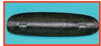
Le verrou en corde à piano est collé d'origine sous la bulle en fibre.
