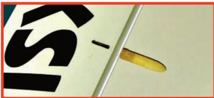
Les sorties de commandes de volets et les fentes pour les guignols sont réalisées en usine.
