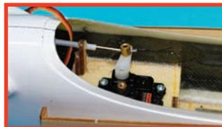
**C'est un montage photo... Mais il montre la solution préconisée par l'auteur pour une commande plus logique : une simple latte ajoutée collée contre la languette d'origine, avec un perçage un peu rehaussé... A faire avant de coller la gaine!**
