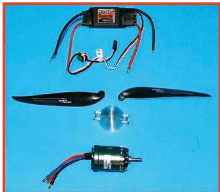
Voici le moteur, le contrôleur et l'ensemble hélice repliable recommandés et bien sûr utilisés par l'auteur.
