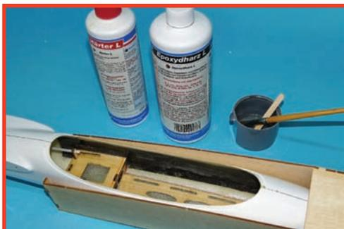
**Mise en place des platines pour la version électrique. C'est à ce stade qu'il faudra penser à rehausser le passage des gaines de**
