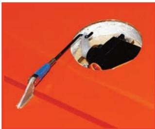
**Les commandes d'ailerons sont très courtes. Un cache thermoformé fourni viendra protéger le servo.**
