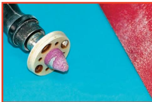
**Pour ajuster le couple avant, l'auteur l'a poncé en l'ayant fixé sur la mini-perceuse.**
