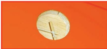
Les puits de servos sont livrés avec l'entoilage déjà découpé et avec une cordelette pour tirer les fils.
