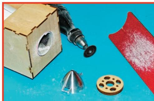
**Les outils pour couper le nez : mini-perceuse, disque à tronçonner et cale à poncer pour la finition.**
